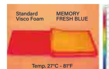
TEST DI TERMOGRAFIA AITEX® A SOSTEGNO DELLA EFFETTIVA FUNZIONALITÀ TERMICA DI MEMORY FRESH BLUE
